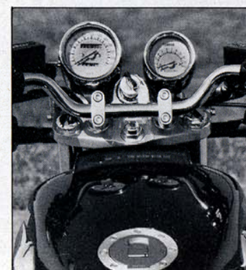
De toerenteller had best iets groter mogen zijn, om de afleesbaarheid te verbeteren. De controlelampjes en temperatuurmeter zitten in een apart controle-paneel op de dummy-tank
