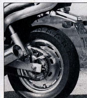
De achtervering wordt verzorgd door twee normale schokbrekers, waarvan de veren in een bus zitten. Er is een haaks ventiel in het schijfwiel gemonteerd, zodat de band makkelijk is op te pompen
