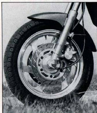
Om de zijwind-gevoeligheid binnen de perken te houden, werd het schijfwiel voor voorzien van grote gaten. De dubbele schijfrem kan het geweld goed aan
